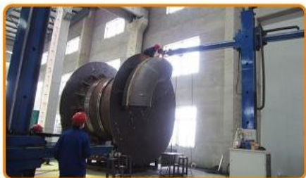
自动焊接 Automatic Welding
