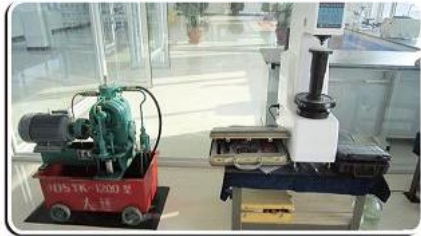
自动试压泵&布氏硬度试验机 Electric Pressure Testing Pump & Binnell Tester
