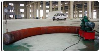
水压试验 Hydraulic Test
