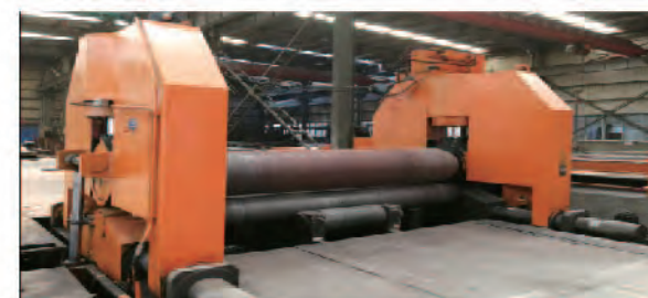
3辊矫直机 / 3-roll leveling machine 工作尺寸 / Working size: 80mm*3300mm*L
