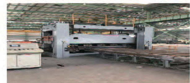
9辊矫直机 / 9-roll leveling machine 工作尺寸 / Working size: 20mm*3000mm*L
