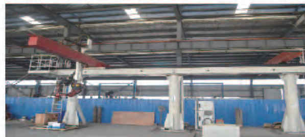
KUKA 9轴自动焊接机器人 / KUKA 9 Axis robot welding 工作尺寸 / Working size: 5M*15M
