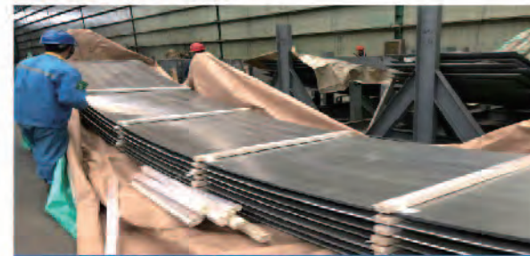
哈氏合金C276+A36复合板-GE/NTPC烟气脱硫吸收塔项目 Supplied Hastelloy C276+A36 Clad Plates to GE for NTPC Flue Gas Desulfurization (FGD)
