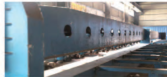
铣边机 / Beveling machine 工作尺寸 / Working size: 10000mm
